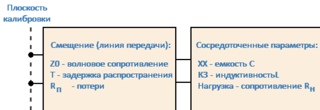
Рисунок 91 — Модель однопортовой меры
